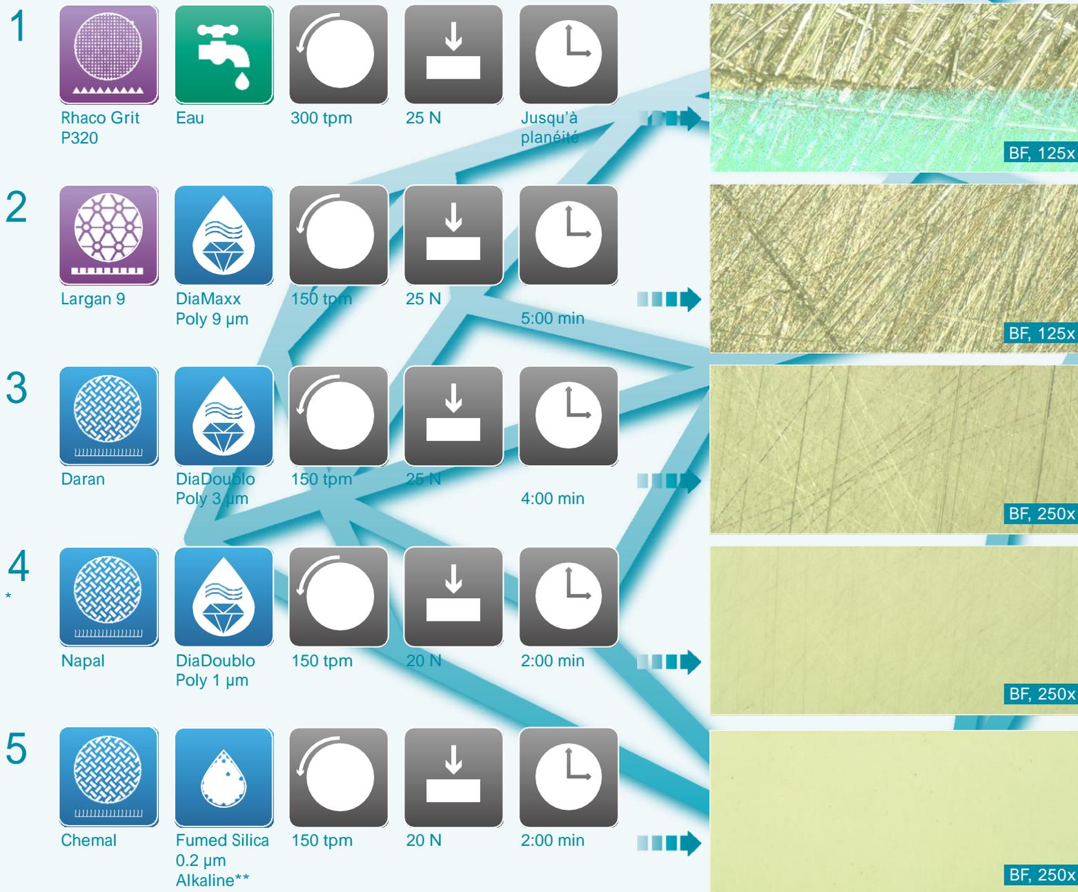
Les temps et les forces sont indiqués pour une préparation en Ø300mm et un diamètre d'échantillon de 40mm.
